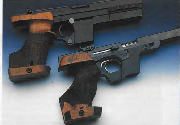
Umbau: Diese Pardini-Schnellfeuerpistole verwandelte der Olympiasieger in eine "GP Schumann". Die Bohrungen im Mündungsteil leiten überschüssige Pulvergase nach oben und stabilisieren so die Waffe. Der Handschuhgriff bringt optimale Kontrolle.
